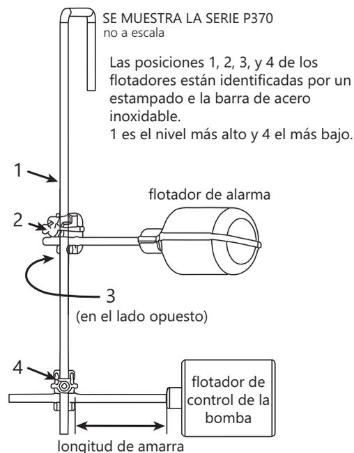
Al realizar el mantenimiento del QuickTree, coloque el cable del interruptor en el canal y luego deslice la varilla de acero inoxidable a través de la abrazadera. Ajuste el tornillo con un destornillador Phillips, teniendo cuidado de no apretar demasiado. Los planos se han estampado en la varilla para designar la posición de flotación, y el tornillo debe apretarse en el plano. La longitud de la correa es la cantidad de cordón entre la abrazadera y el flotador.
